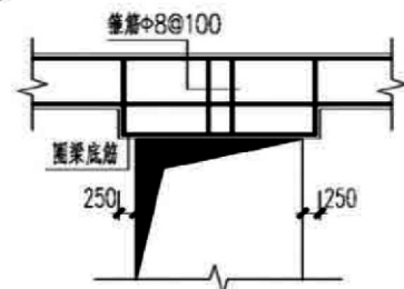
图一 圈梁和洞顶过梁做法
