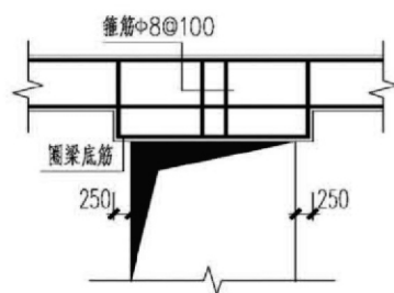
图一 圈梁和洞顶过梁浇筑做法
